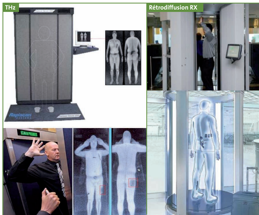
FIG. 3 : Nouveaux scanners corporels utilisés dans les aéroports. A gauche, appareils à ondes TéraHertz (THz). A droite, appareils à rétrodiffusion de rayons X.
