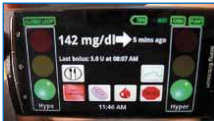
FIG. 1 : Plateforme de communication entre la mesure continue du glucose et la pompe à insuline, gérant l'algorithme de contrôle pour une insulinothérapie en boucle fermée ambulatoire.
