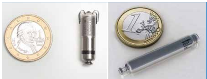
FIG. 4 : Pacemaker sans sonde : marque Medtronic à gauche, Saint Jude Medical à droite.
