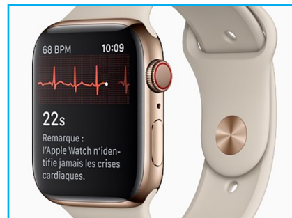
Fig. 5 : L'Apple Watch (depuis la série 4) permet d'enregistrer un ECG 1 dérivation entre le bracelet et le bouton situé sur le côté droit de la montre.
