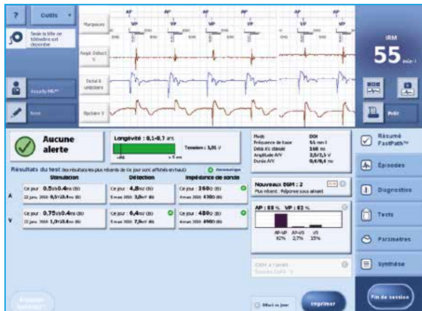
Fig. 1 : Page d'accueil d'un stimulateur cardiaque double chambre avec les seuils de stimulation, détection, impédance de sondes et batterie, et mémoires Holter.
