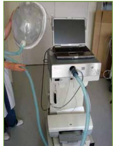
**FIG. 1 :** Un appareil de calorimétrie indirecte.
