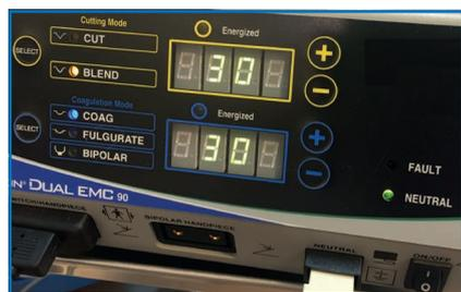
**FIG. 3 :** Exemple de générateur de radiofréquence. Plusieurs modes sont possibles pour favoriser la vaporisation ou la coagulation des tissus. Le nom commercial de l'appareil a été masqué.
