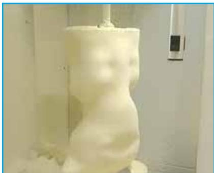
**Fig. 3 :** Fraisage numérique et réalisation du positif en mousse haute densité après rectification informatique.
