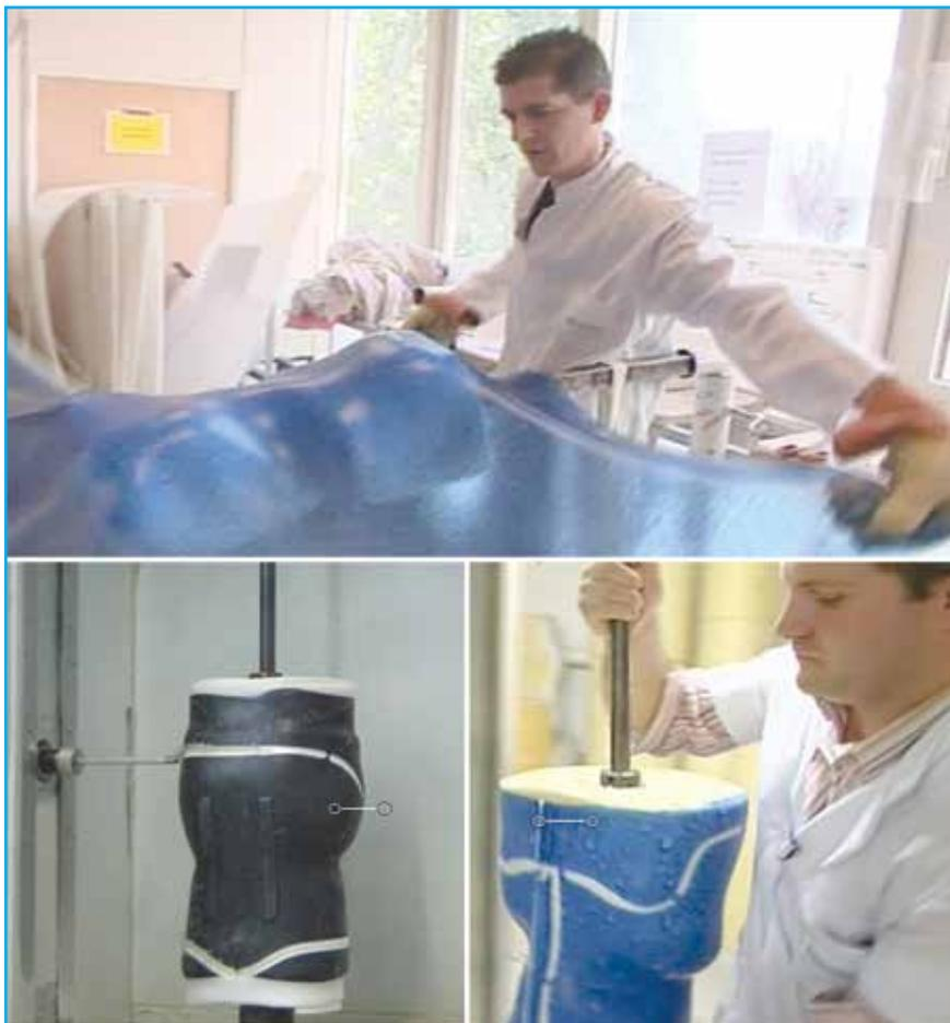
**Fig. 4 :** Dernières étapes de réalisation du corset avec application du polymère plastique chauffé sur le positif et découpage des fenêtres par la fraiseuse 3D. Le corset moulé et fenêtré est ensuite sorti de la fraiseuse pour la réalisation des finitions.
