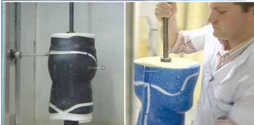
**Fig. 4 :** Dernières étapes de réalisation du corset avec application du polymère plastique chauffé sur le positif et découpage des fenêtres par la fraiseuse 3D. Le corset moulé et fenêtré est ensuite sorti de la fraiseuse pour la réalisation des finitions.
