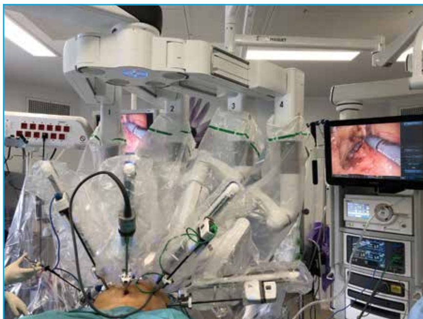
Vue générale de la patiente installée avec les différents instruments coelioscopiques actionnés au moyen des bras du robot.
