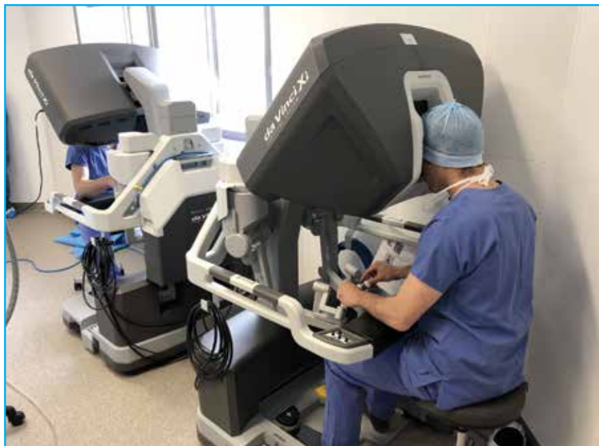
Réalisation d'une intervention de chirurgie gynécologie à l'aide du robot Da Vinci. Vue du poste chirurgical de commande.
