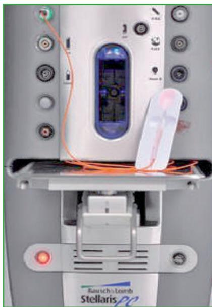
FIG. 6 : Position du laser en façade (voyant de fonction à gauche, clé à droite) et emplacement pour le branchement de la fibre en haut.
