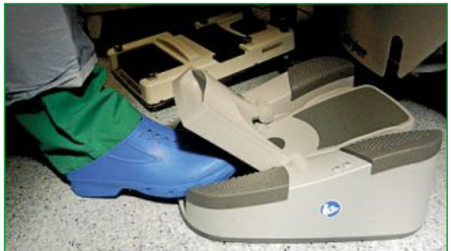
FIG. 4 : Nouvelle pédale sans fil Bluetooth® plus horizontale. Soulever le clapet inférieur donne l'accès au bouton laser.
