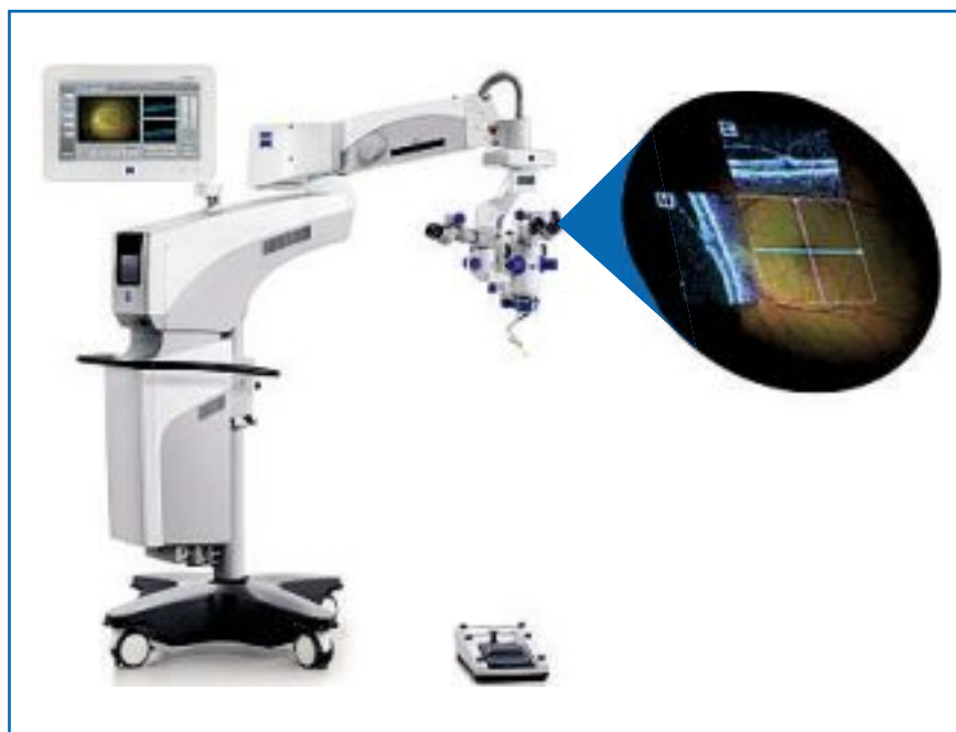
FIG. 1 : Micro-OCT Zeiss OPMI LUMERA 700 et RESCAN 700. Le module OCT est visible dans le pied du microscope. Les images sont injectées dans les oculaires et se surajoutent à la visualisation classique du micro.
