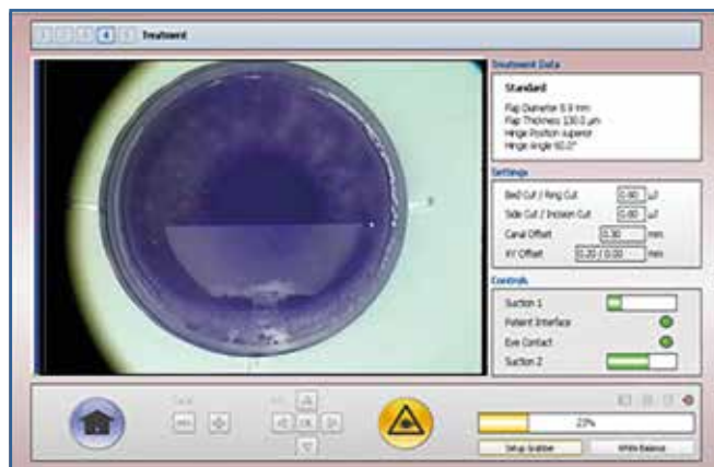
Fig. 6 : Écran du laser FS200. L'affichage comprend les valeurs d'énergie, le diamètre et l'épaisseur du capot. Les curseurs verts valident les niveaux d'aspiration des deux phases du docking . Le contrôle visuel en temps réel de la découpe de la lamelle est également affiché.
