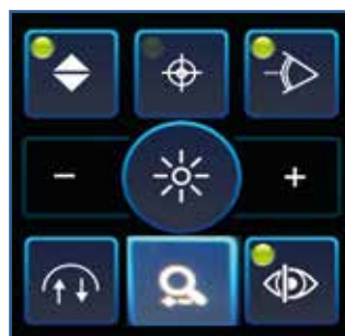
Fig. 16 : Pavé tactile de contrôle du microscope sur l'écran du moniteur (GUI interface). Les trois boutons du haut (de gauche à droite) : on/off du spot pour le réglage de la hauteur (Z), on/off du spot de l'eye-tracker, on/off du spot de fixation. Les trois boutons du bas : descente/montée du plume evacuation unit, sélection du grossissement de l'image, on/off de la lame à fente. La barre centrale permet l'ajustement de la luminosité.
