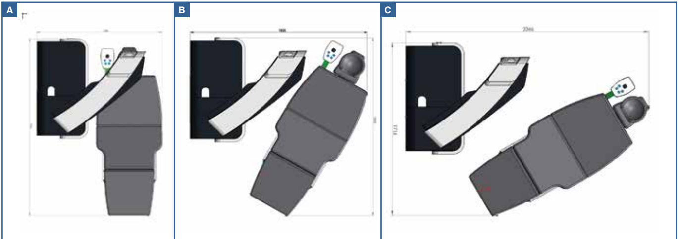
Fig. 11A: Position du lit rotation 0° : traitement Excimer. B : position du lit rotation 30° : arrivée/départ du patient. C : position du lit rotation 60° : traitement de découpe femtoseconde.
