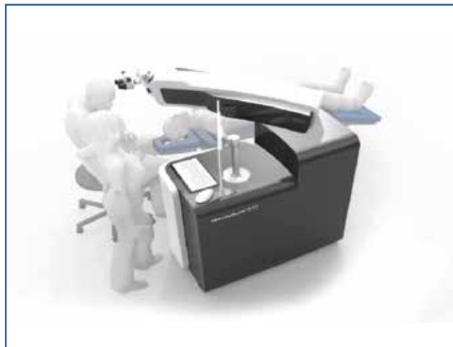
Fig. 9 : Notez le bras porteur de la tête laser, déporté et très fin.
