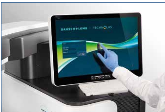
Fig. 12 : L'écran de contrôle et de monitoring du 317.
