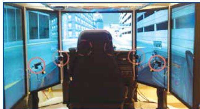
Fig. 3 : Simulateur de conduite utilisé par les auteurs. Les cercles rouges repèrent les eye trackers. Le simulateur comporte 5 écrans vidéo disposés sur un angle horizontal de 225° et un angle vertical de 37°. La luminosité des écrans est un facteur limitant qui a incité les auteurs à construire un système éclairant permettant de reproduire l'éblouissement par les phares des autres automobilistes [5].
