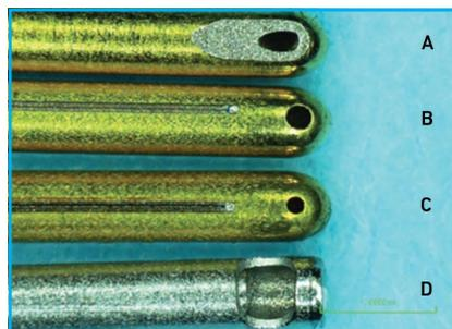
**Fig. 4 :** Différents aspects des extrémités distales des vitréotomes hypersoniques et à guillotine 23 G (d'après [8]). **A :** vitréotome hypersonique avec ouverture en forme de goutte de 255  $\mu\text{m}$  de calibre. **B :** vitréotome hypersonique avec ouverture ronde de 225  $\mu\text{m}$  de diamètre. **C :** vitréotome hypersonique avec ouverture ronde de 175  $\mu\text{m}$  de diamètre. **D :** vitréotome à guillotine.
