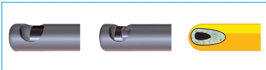
**Fig. 1 :** Aspects schématiques de l'extrémité des vitréotomes. **À gauche**, vitréotome à guillotine simple et guillotine double. L'aiguille interne se déplace dans l'aiguille externe. **À droite**, vitréotome hypersonique. L'aiguille est simple et le port toujours ouvert.
