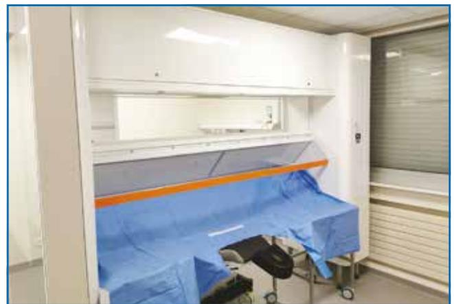
**Fig. 2 :** SurgiCube côté chirurgien. On retrouve le champ opératoire qui va permettre d'installer les instruments sur les deux tables opératoires de part et d'autre du brancard. On ajoutera bien entendu un champ opératoire conventionnel au niveau de l'œil opéré du patient.
