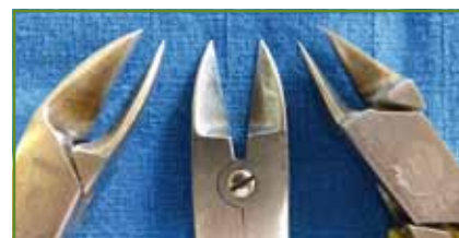
FIG. 8 : Gros plan sur les mors plats de pinces coupantes.
