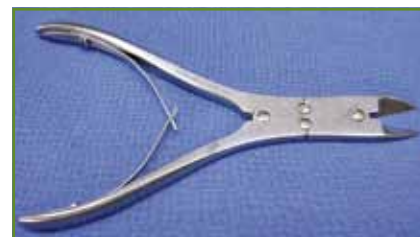
FIG. 7 : Pince coupante démultipliée à mors plats.
