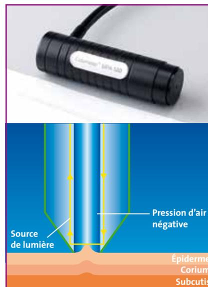
FIG. 10 : Cutometer®, test d'aspiration, Courage & Khazaka, Cologne, Allemagne.
