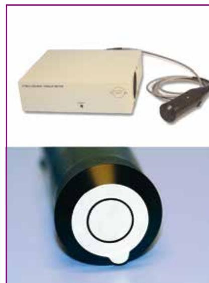
FIG. 9 : Torque Meter®, test de torsion, Dia-Stron Ltd, Hampshire, Royaume-Uni.
