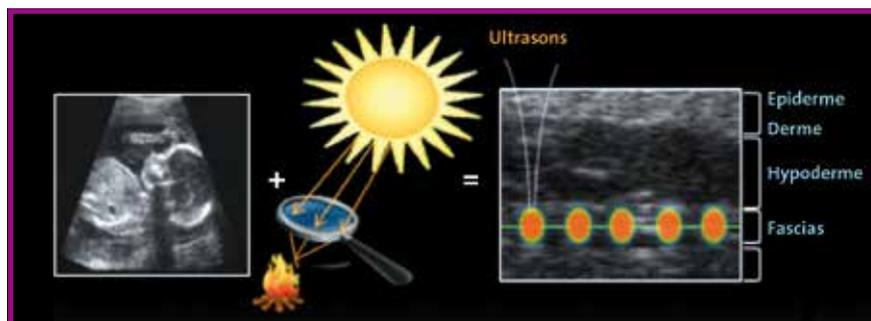
**FIG. 1 :** Le principe de la focalisation peut être comparé à l'effet d'une loupe sur les infrarouges du spectre solaire : en concentrant les rayons en un point focal, on obtient un effet thermique puissant.
